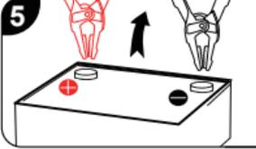
ジャンプスタート後、すぐにバッテリークランプを車両のバッテリーから取り外します。
